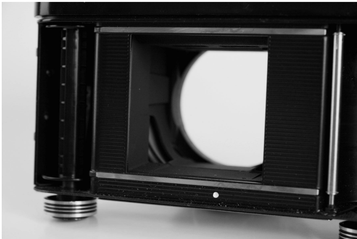
Fig. 2.4. Camera obscură la aparatul foto de mediu format 6x6cm Pentacon Six TL
