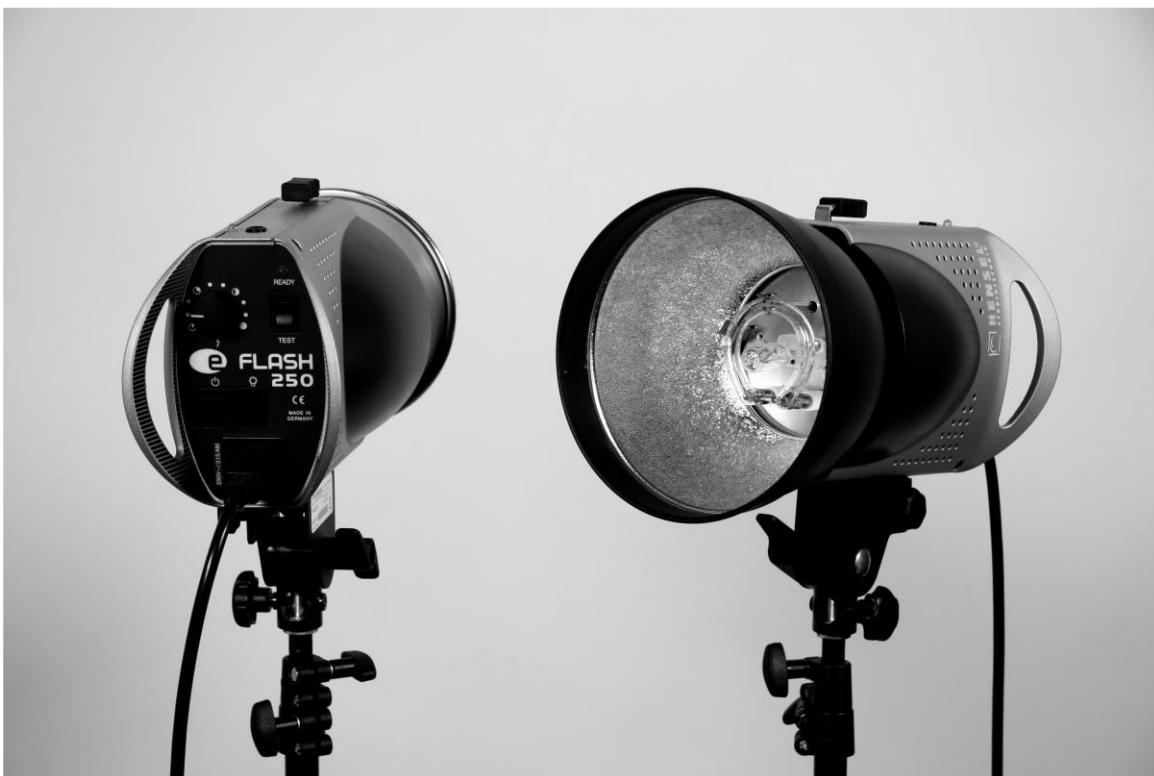
Fig. 2.34. Sistem de 2 flash-uri care lucrează sincron (principiul master-slave )
